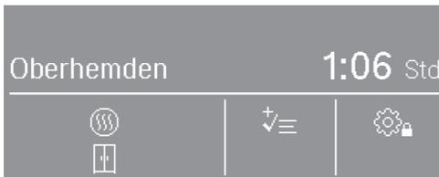
Unter dem Symbol
