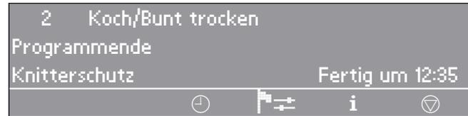
Das Programmende wird im Display angezeigt, der Summer ertönt und es setzt der Knitterschutz-Intervallbetrieb ein.
