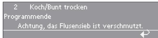
Diese Display-Anzeige erscheint, wenn das Flusensieb gereinigt werden muss. Die Reinigung bitte sofort nach Programmende vornehmen.
