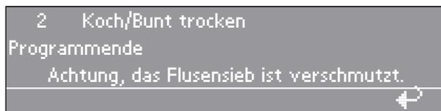
Diese Display-Anzeige erscheint, wenn das Flusensieb gereinigt werden muss. Die Reinigung bitte sofort nach Programmende vornehmen.
