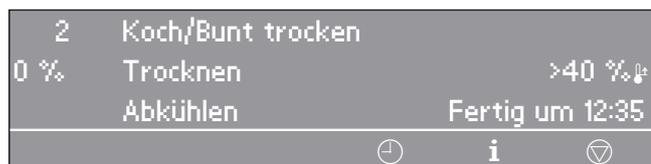
In der 2. Displayzeile, hier Trocknen, erscheint zusätzlich die aktuelle Restfeuchte (>40%) und Heizung eingeschaltet. In der 3. Displayzeile erscheint der nachfolgende Programmblock.
