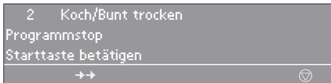
Soll das Programm fortgesetzt werden, ist das durch Betätigung der Taste "START" möglich.
