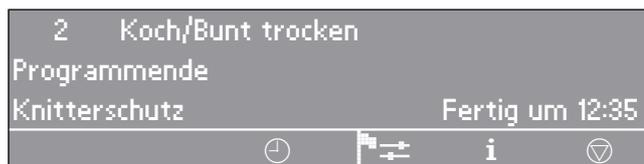
Das Programmende wird im Display angezeigt, der Summer ertönt und es setzt der Knitterschutz-Intervallbetrieb ein.
