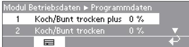
Aus der Programmliste ist das entsprechende Programm auszuwählen und durch Drücken des Drehwahlschalters erscheint zunächst die Auflistung aller Programmstarts von Programm 1 "Koch/Bunt trocken plus" mit Datum und Startzeit.
