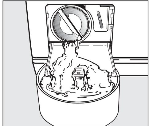
■ Lösen Sie den Laugenfilter, bis das Wasser ausläuft.
