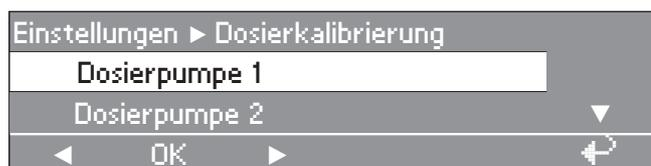
Anwahlmöglichkeiten: Dosierpumpe 1 bis 13
