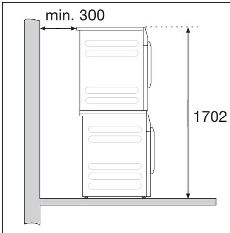
Die Waschmaschine kann mit einem Miele Trockner als Wasch-Trocken-Säule aufgestellt werden. Dazu ist ein Zwischenbausatz (WTV, nachkaufbares Zubehör) erforderlich.
