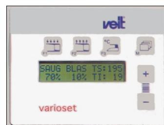
Über die elektronische Steuereinheit bestimmen Sie die Saug- und Blasleistung schnell mit einem Tastendruck. Die Soll- und Ist-Temperatur des Büglers wird auf das Grad genau angezeigt.
