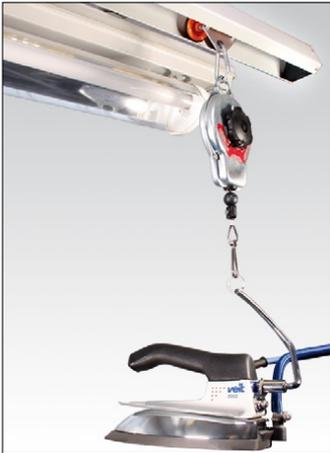
Für ermüdungsarmes Arbeiten sorgt die Büglerschwebe mit Balancer, der den Bügler schwerelos über der Bügelfläche positioniert.
